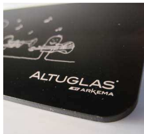
Marquage utilisé ici: Laser YAG (1064nm - 2000 mm/s - 100 kHz)
