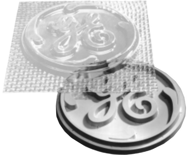
Fig. 1.14 : Moule type de formage sous vide
