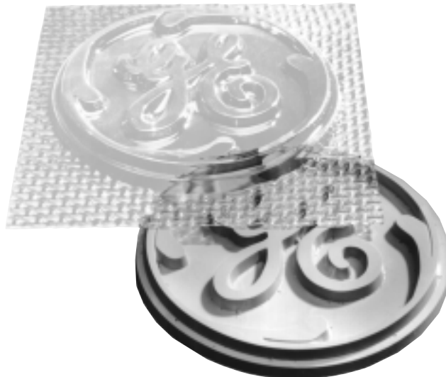
Fig. 1.14 : Moule type de formage sous vide
